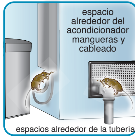
Cerrar y cubrir todas las aberturas en su casa
